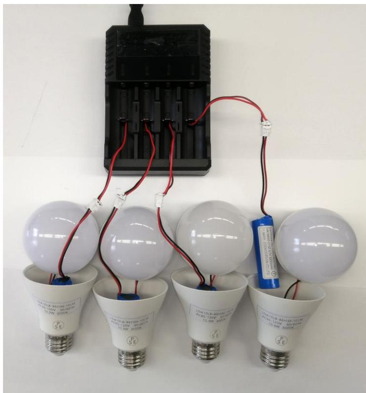
2. 弊社 LED 照明製品では通電による LED 点灯中に内蔵電池への充電が行われます。
